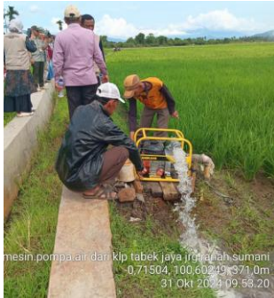
Gambar 8. Pemanfaatan pompa atasi kekeringan lahan sawah yang hampir 3 Minggu tidak mengalami hujan.
